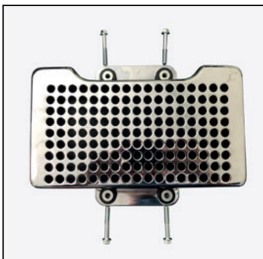
Étape 3 : installation des silentblocs et entretoises sur le radiateur.
