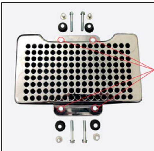
Étape 2 : perçage de la grille de radiateur en diamètre 12,5 mm.
